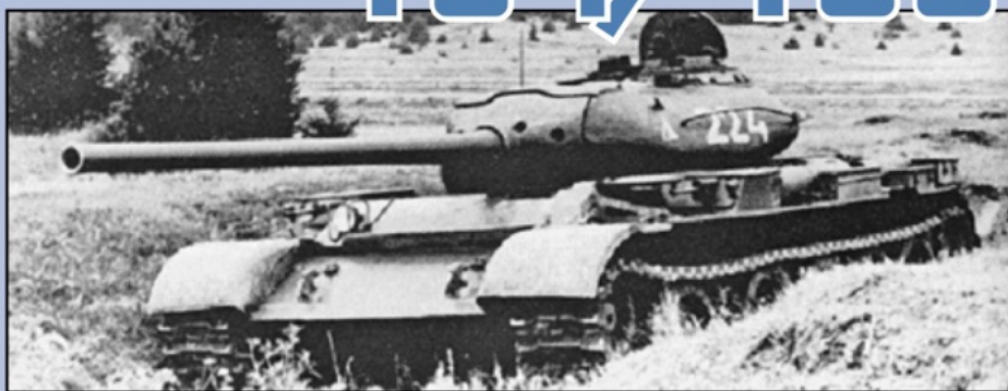
Een T-54-1 model 1946 in een defensieve positie. De mitrailleurtorentjes op de beide spatborden zijn duidelijk zichtbaar.
